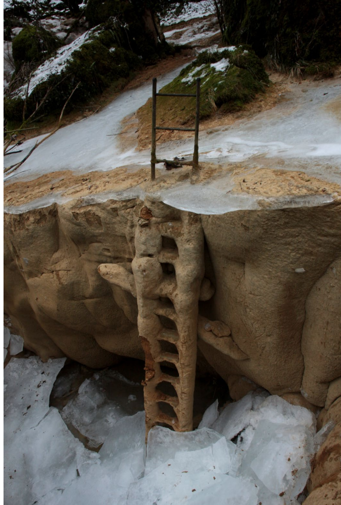
Dans la rivière Dard asséchée à Baume-les-Messieurs, la partie immergée de l'échelle est totalement entufée sur une épaisseur de 5 à 10 cm, la partie émergée est intacte. ©P. Collin
