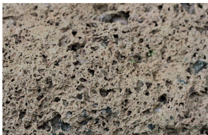
Gros plan sur le tuf et ses vides, qui confèrent à la roche ses qualités isolantes et l'usage traditionnel qui en a été fait (paroi des cheminées). ©P. Collin
